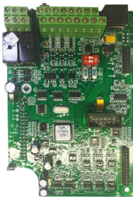
Рисунок 9.5 – Плата управления с покрытием лаком
