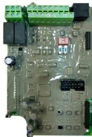
Рисунок 9.4 – Плата управления с покрытием компаундом
